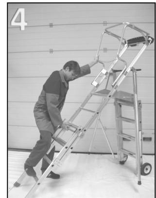
Même technique coté roues, le pied en appui sur le barreau.
