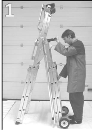
Vérifier que le plancher est en place et bien en appui sur la barre de maintien.
