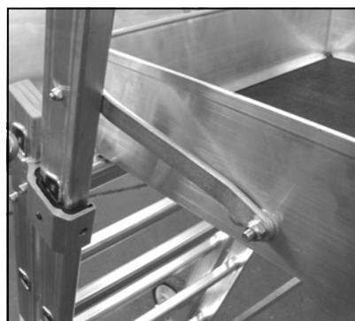
3 - Emboîter la bielle de la tablette dans le même trou de la plinthe en intercalant la rondelle (5) et la bielle du plancher.
