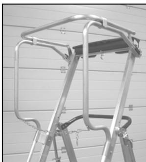
Mousqueton servant à accrocher la chaînette lorsque l'opérateur n'est plus sur la plateforme.
