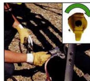
5. Tourner la clé vers la **DROITE** jusqu'au recul automatique de celle-ci.
