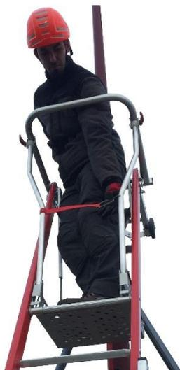
**13. Verrouiller la sous lisse arrière à l'aide du crochet, en l'insérant dans la bielle.**
