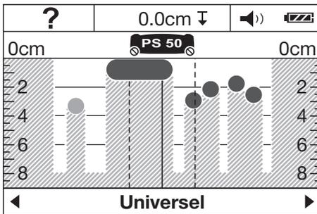
Si de nombreux objets sont affichés, cela signifie que le mur contient probablement de nombreuses cavités (brique creuse) ou que le scannage se fait le long de l'objet.
