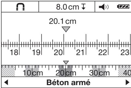
Le type d'affichage peut être changé dans tous les modes de scannage pour la mesure de distance. Ce faisant, seul l'affichage est changé, pas le mode de scannage sélectionné.
