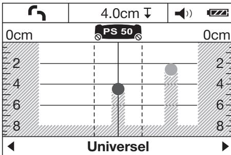
Dans la zone de détection se trouve un objet en métal non ferreux, par ex. un tube en cuivre. La profondeur de mesure approximative est de 4 cm (1.6 in). L'appareil émet un signal sonore.
