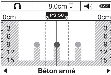
Dans la zone de détection se trouve un objet en métal ferreux, par ex. un fer d'armature. À gauche et à droite de cela se trouvent d'autres objets hors de la zone de détection. La profondeur de mesure approximative est de 8 cm (3.1 in). L'appareil émet un signal sonore.
