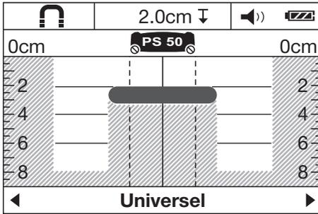
Dans la zone de détection se trouve une surface métallique étendue, par ex. une plaque métallique. La profondeur de mesure approximative est de 2 cm (0.8 in). L'appareil émet un signal sonore.
