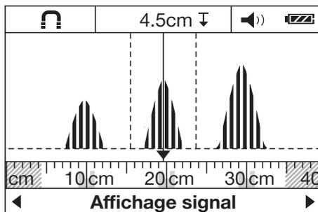
Le mode de scannage « Affichage signal » est conçu pour une utilisation sur tous les matériaux. La puissance du signal à la position de mesure considérée est affichée. Ce mode de scannage permet de localiser précisément des objets très rapprochés, de même qu'il permet de mieux évaluer des constructions de matériaux complexes à l'appui des caractéristiques du signal.
