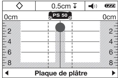
Dans la zone de détection se trouve un objet non métallique. Il s'agit d'un objet en plastique/ bois proche de la surface ou d'une cavité. L'appareil émet un signal sonore.
