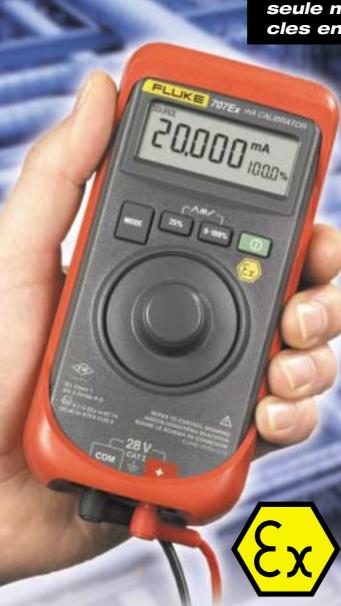
Le Fluke 707Ex est un calibrateur de boucles haute sécurité intégrée conçu pour les environnements à risque d'explosion. Le Fluke 707Ex est certifié conforme à la directive ATEX (Ex II 2 G Eex ia IIC T4) pour les Zones 1 et 2. Le 707Ex est également certifié conforme aux prescriptions N.I. Classe 1, Division 2, Groupes A à D de Factory Mutual.
